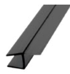
ET-80-11-B 防水條 材質 PVC 押出成型 備註 適用厚度 8mm / 長度 2.2m
