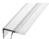
ET-80-14-2 / ET-80-26 擋水條 材質 PVC 押出成型 備註 適用厚度 8mm / 長度 2.2m 適用厚度 10mm / 長度 2.2m
