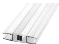
M10-180T-3 / M10-180T-4 180 度平面磁鐵條 材 質 PVC 押出成型 備 註 適用厚度 8mm / 長度 2m 適用厚度 10mm / 長度 2.2m
