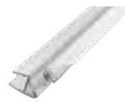
ET-80-31+ET-80-32 135度防水條 材質 PVC 押出成型 備註 適用厚度 8-10mm / 長度 2.2m
