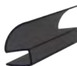
IT-22-1-B 擋水條 材質 PVC 押出成型 備註 適用厚度 8mm / 長度 100cm
